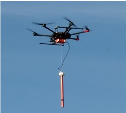
图 7 接收器、磁棒与飞机的接驳(软连接)
