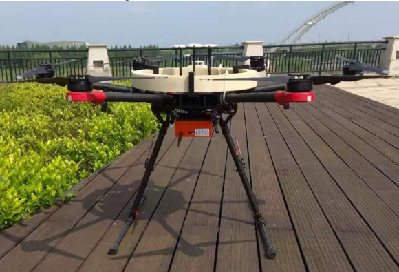
图 6 接收器、线圈与飞机的接驳
