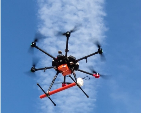
图 8 接收器、磁棒与飞机的接驳(硬连接)
