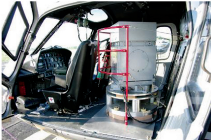
图 3 GT-2A 直升机航空重力勘查系统 Fig.3 GT-2A helicopter airborne gravity survey system
